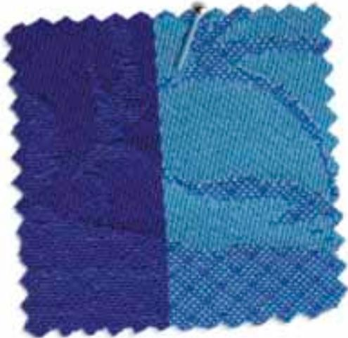
**Jacquard** – Webtechnik, bei der jeder Kettfaden einzeln gesteuert werden kann. Dadurch sind besonders fein gezeichnete und variationsreiche Dessinierungen im Gewebe möglich.
